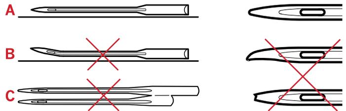
*Hinweis: Wechseln Sie die Nadel regelmäßig. Immer mit einer geraden und spitzen Nadel (A) arbeiten.*
